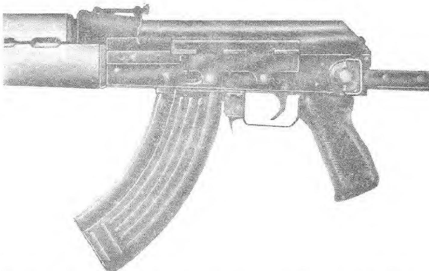
Sl. 23. — Izgled postolja za nosač pasivnog nišana za AP 7,62 mm M70AB2N i PM 7,62 mm M72AB1N
